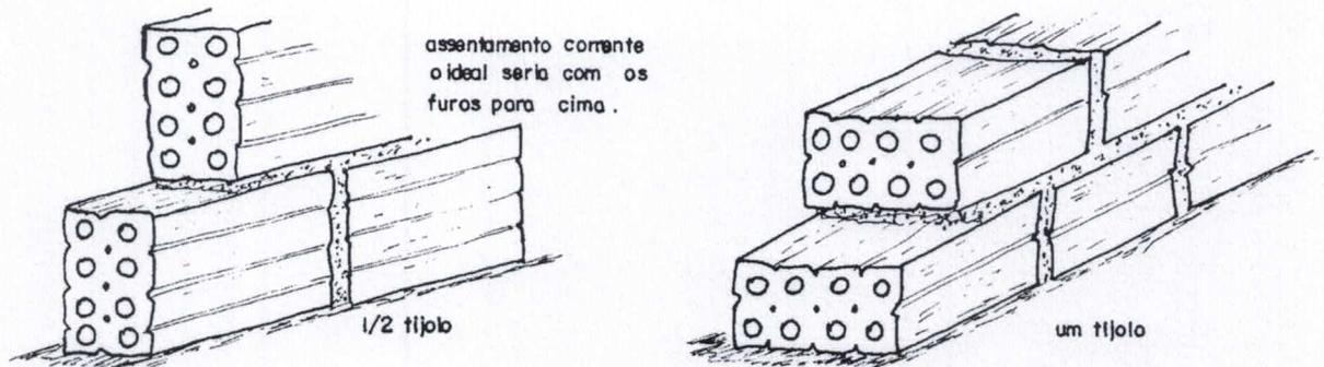
Figura 1 - Execução de alvenaria utilizando tijolos furados.
